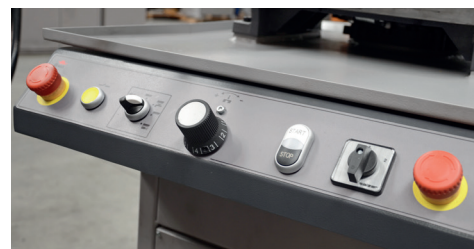
Sämtliche Bedienelemente sind von der Vorderseite der Maschine aus zugänglich
