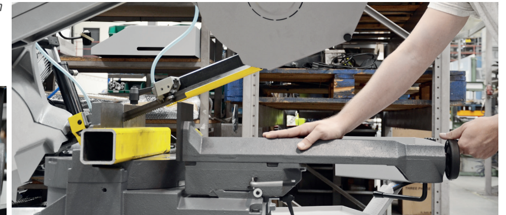
Die Schnellspanneinrichtung für Serienschritte öffnet nur einige Millimeter um das Material vorzuschieben
