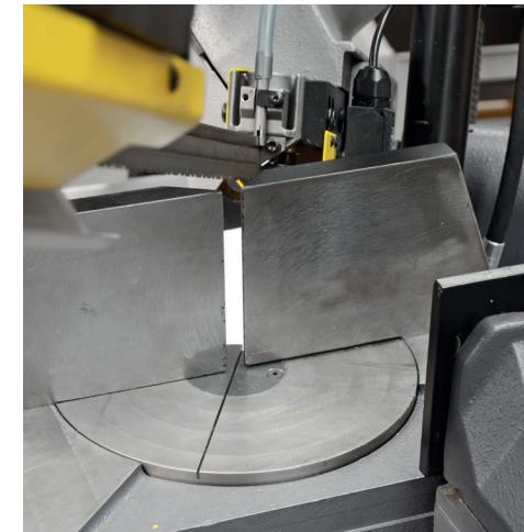
Die Maschine verfügt über einen runden Auflagetisch, der bei Gehrungsschnitten mit dreht. Dadurch gibt es keine Einschnitte in die Auflagenfläche
