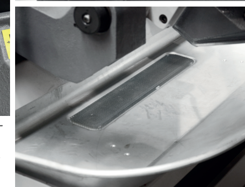
Die große Spänewanne sorgt für eine einfache Entsorgung der Späne und für ein trockenes Umfeld der Säge
