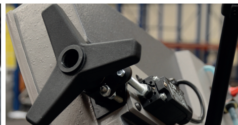
Die Sägebandspannung ist mit einer Sägebandspannungs- und Sägebandbruchüberwachung ausgestattet
