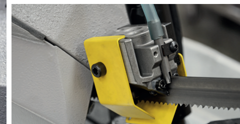
Das Sägeband wird mittels geschliffenen Hartmetallplatten präzise geführt
