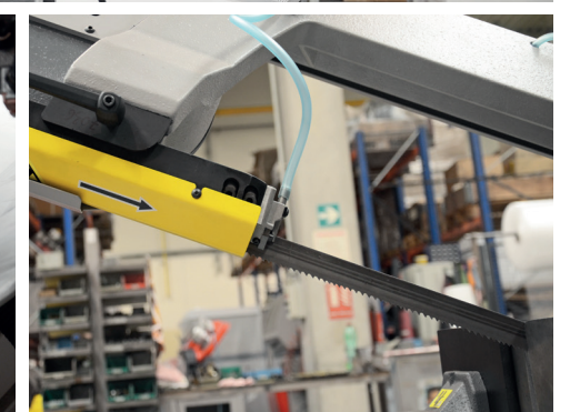
Dank dem einstellbaren Führungsarm, kann die Sägebandführung stets möglichst nahe zum Material gestellt werden
