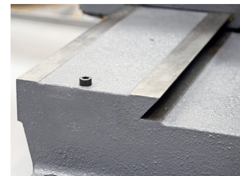
Der Spannstock ist für den Querverschub bei Gehrungsschnitten auf einer Prismenführung gelagert
