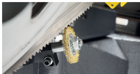
Eine synchron, angetriebene Spänebürste sorgt stets für freie Spankammern
