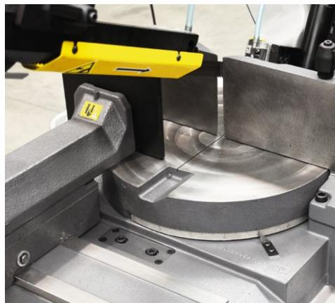
Synchron drehbarer Tisch des Hauptspannstockes.
