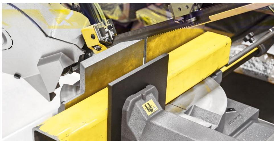
Der Schnellvorschub des Hauptspannstockes ermöglicht, die Spannbacke gemäß der Materialgröße in einigen Sekunden schnell neu einzustellen
