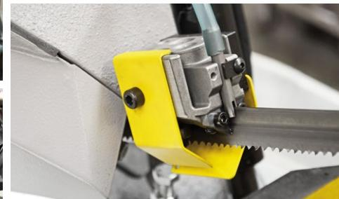
Die hochpräzisen, geschliffene Hartmetall-Seitenführungen sorgen für stetige Schnittgenauigkeit.
