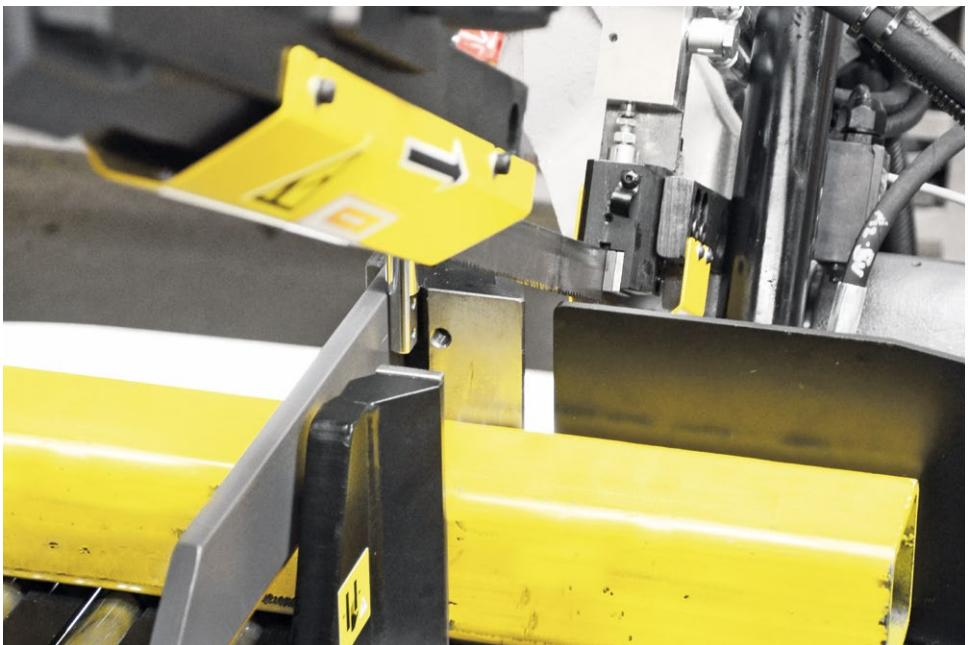
Der Hauptspannstock ist so konzipiert, dass auch bei den Gehungsschnitten, die in der automatischen Betriebsart bis zu 45° manuell einstellbar sind, eine extrem kurze Länge der Reststücke von 20 mm erreicht wird.
