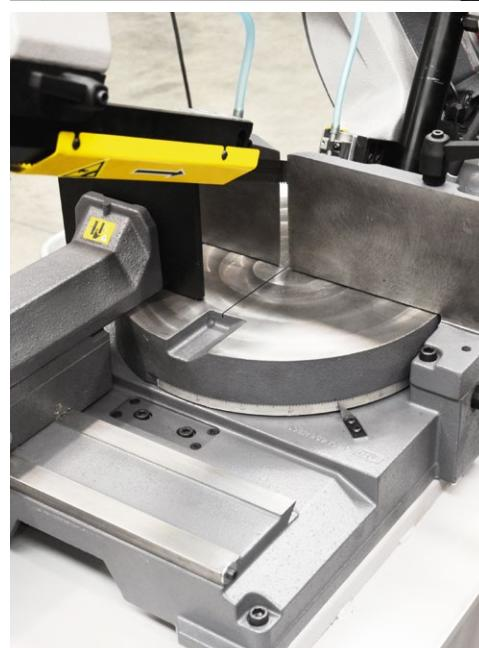
Synchron drehbarer Tisch des Hauptspannstockes.
